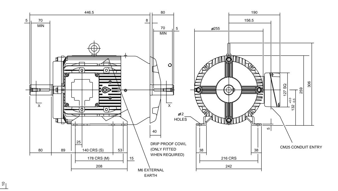
TERMINAL BOX POSITION : - CAN BE ARRANGED AT EITHER 9, 12 OR 3 O'CLOCK BY MOVING FEET.
